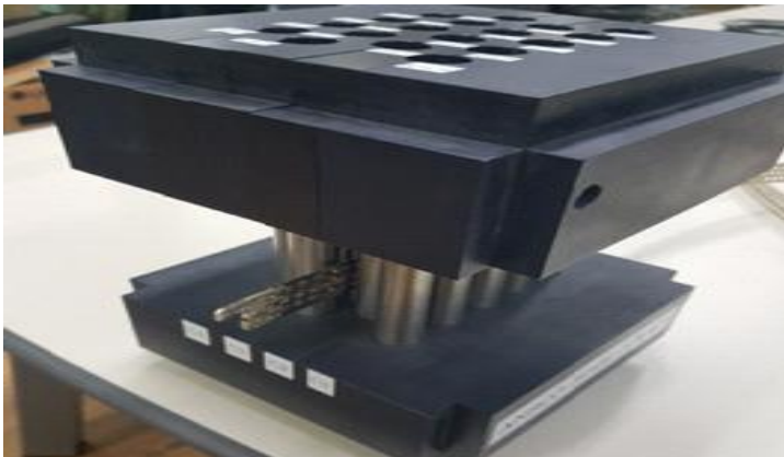
그림 35. AIVIS 장비 Lance 전열관 손상 실증시험
