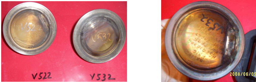
그림 4.17 표준원전 역지밸브 검사결과(HB3,4 10차) 디스크 손상상태
