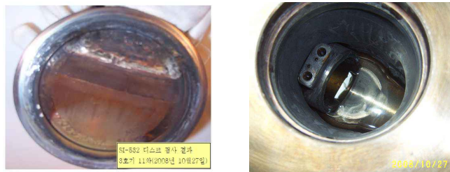
그림 2.7 역지밸브(밸브-A) 디스크 / 시트 검사결과(HB3-11차)
