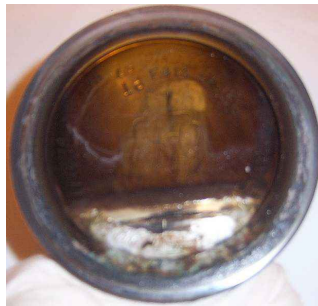
그림 4.18 역지밸브(HB3 밸브-A) 11차 검사결과 디스크 손상 상태
