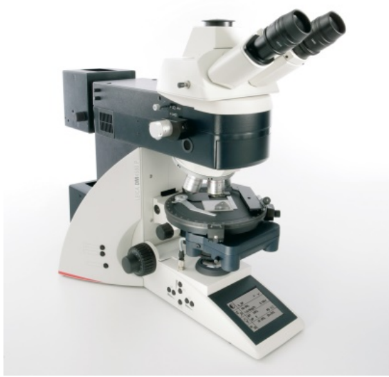
그림 10. 접합재의 미세조직 관찰에 사용된 광학현미경
