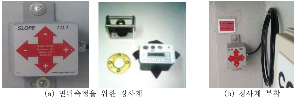
그림 3.23 구조물의 변위측정을 위한 경사계
