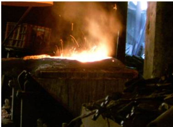
Photo. 3.2 Pour molten metal into a casting
