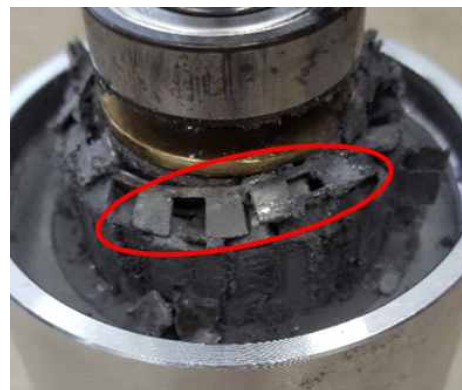
(d) Pole-piece breakage
