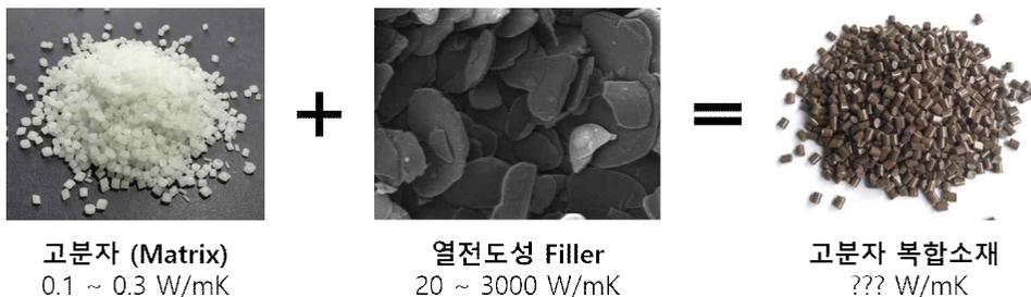
**Figure 1.** 고분자 복합소재의 열전도도.
