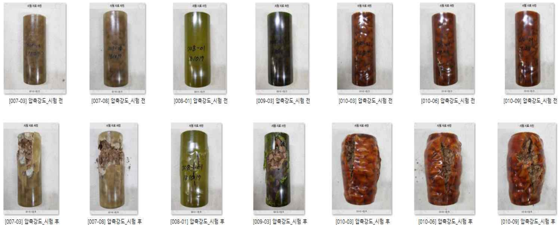
그림 33. 압축강도 측정 전·후의 모습 - 측정 전(위), 측정 후(아래)
