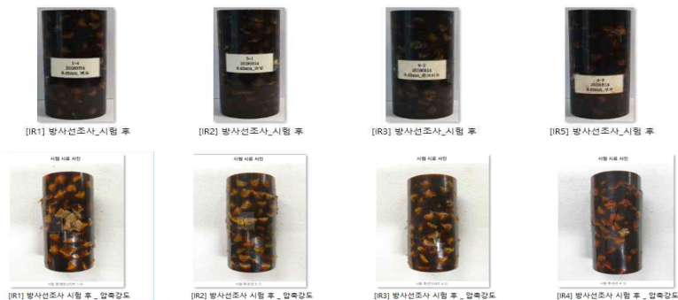
그림 38. 방사선 조사시험 후 압축강도 측정 전·후의 모습 - 측정 전(위), 측정 후(아래)
