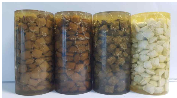
그림 31. 슬러지별 폴리머 고화체 모습
