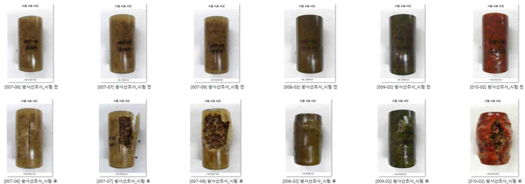
그림 35. 침수시험 후 압축강도 측정 전·후의 모습 - 측정 전(위), 측정 후(아래)
