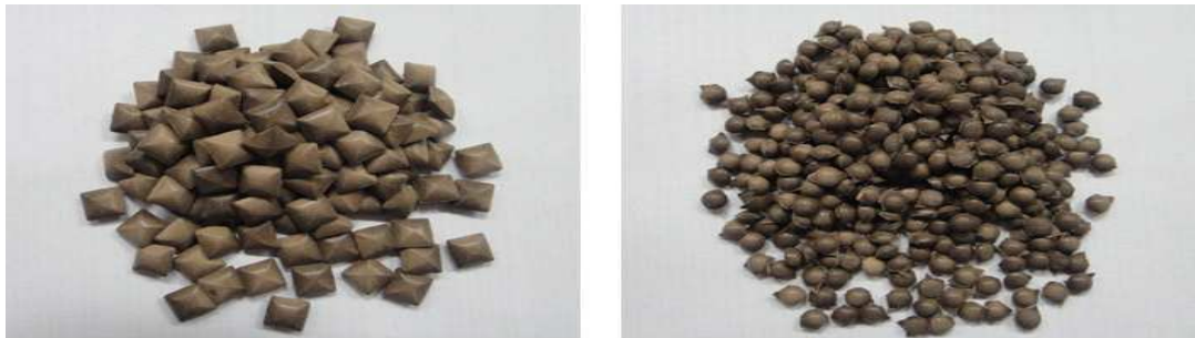
그림 26. 제조된 펠렛의 모습 - Tertragonal shape(L), Circular shap(R)
