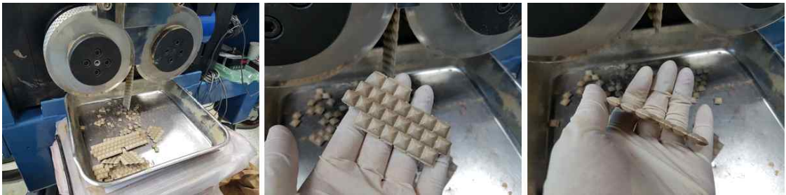
그림 27. 고감용화 성형장치를 이용한 펠렛 제조 모습
