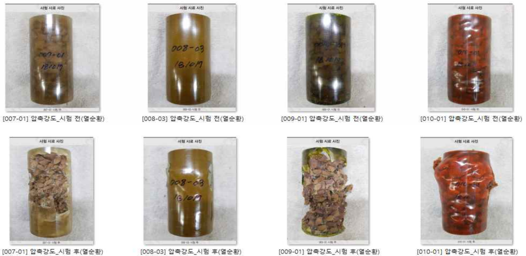
그림 36. 열순환 시험 후 압축강도 측정 전·후의 모습 - 측정 전(위), 측정 후(아래)
