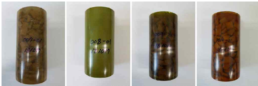
그림 30. 폴리머 혼합비율별 고화체 모습(007, 008, 009, 010)
