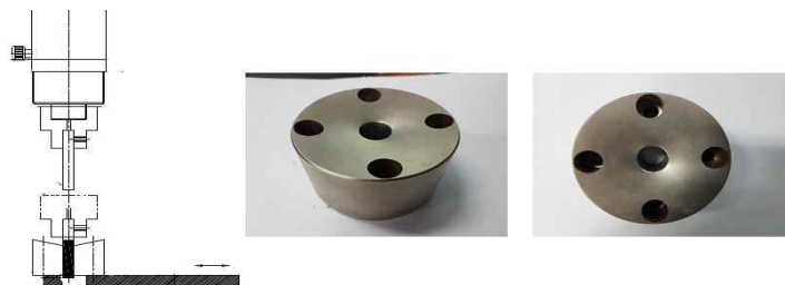
그림 14. Uniaxial compressor's concept for compression of powder
