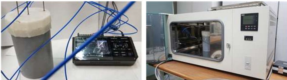
그림 18. 열전대를 이용한 온도측정 모습 - 상온 경화(L), 항온조 내의 50°C 경화(R)
