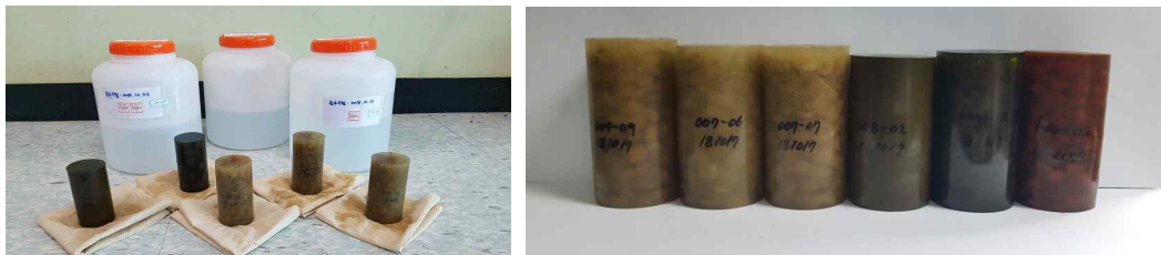
그림 34. 침수시험 시편 모습 - 종료 직 후(L), 실온 건조 후(R)
