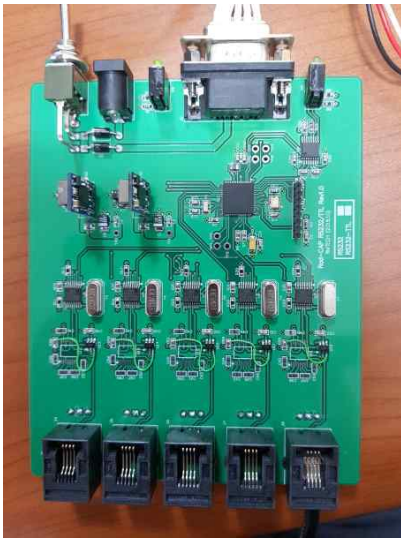
[그림 29] 방사선측정기 테스트 DAQ 제작
