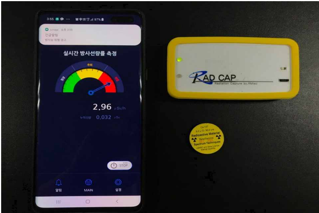
[그림 47] 위험수준의 방사선량 측정시 경고알람
