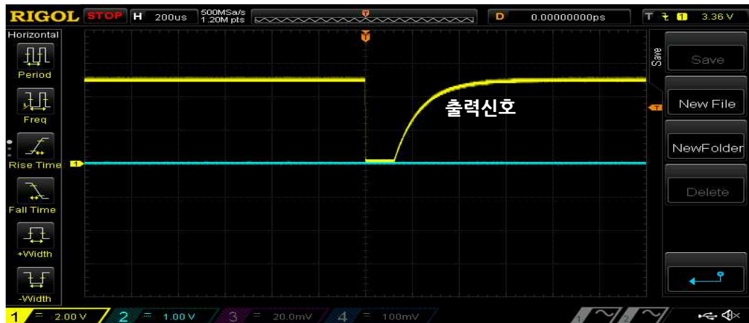
[그림 16] 방사선 측정 출력신호 확인
