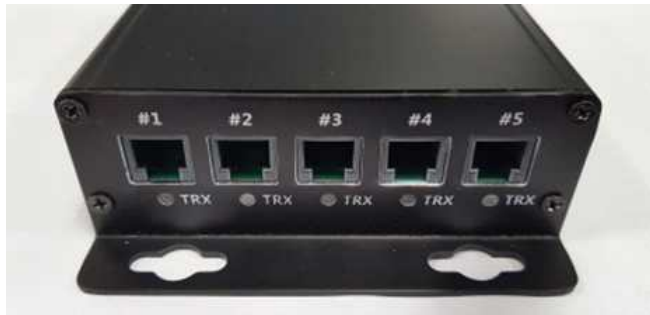
[그림 29] 방사선측정기 테스트 DAQ 제작
