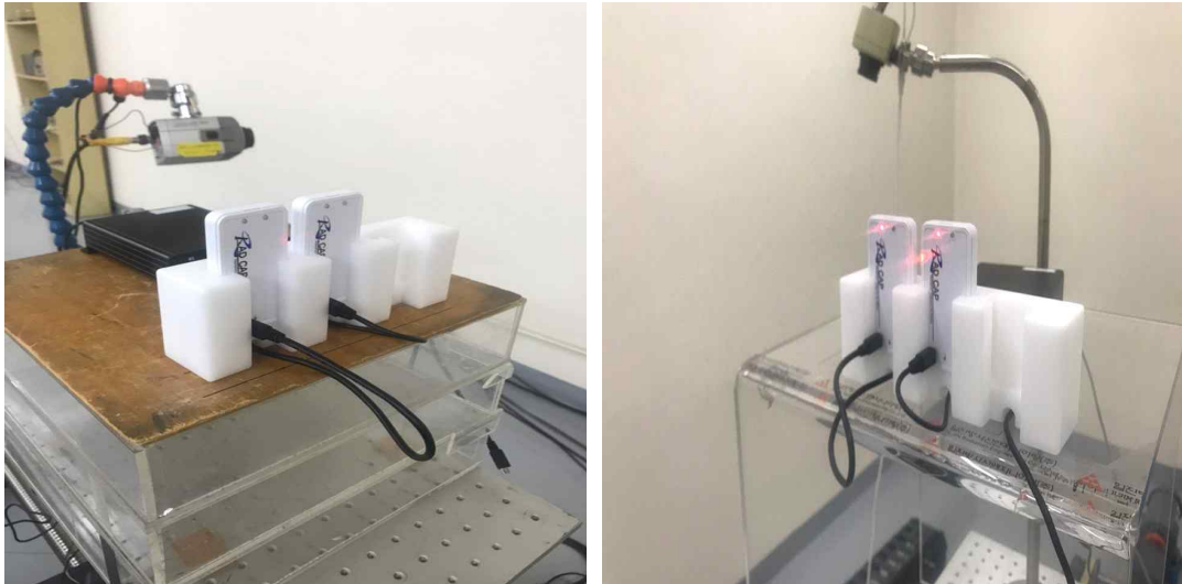
[그림 38] 방사선량 측정 선형성 테스트
