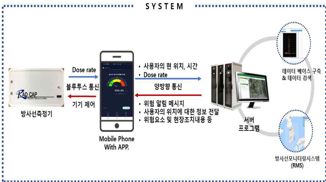
[그림 2] 사물인터넷 기반 방재시스템 개요도
