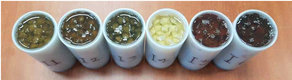
Fig. 45. 특성평가에 사용되어진 고화체 시험 시편
