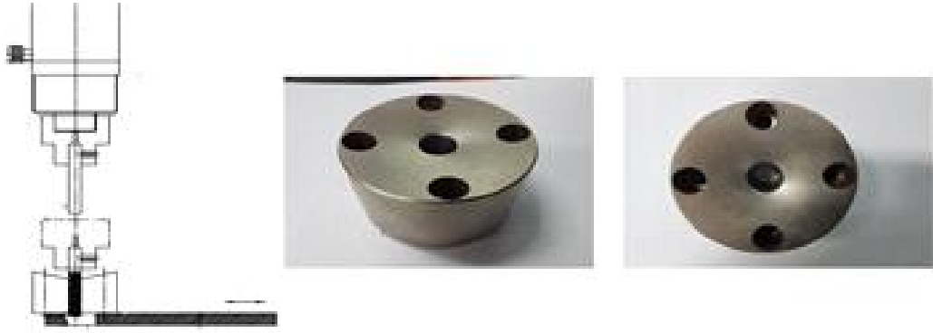
Fig. 28. 일축 압축을 위한 시험장치 및 압축 다이
