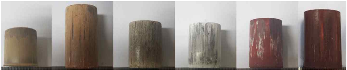
Fig. 29. 일축 압축을 이용한 시료의 압축 평가 (좌측부터 벤토나이트, 토양, 콘크리트, 농축 폐액, Sump 슬러지, 부식 슬러지)
