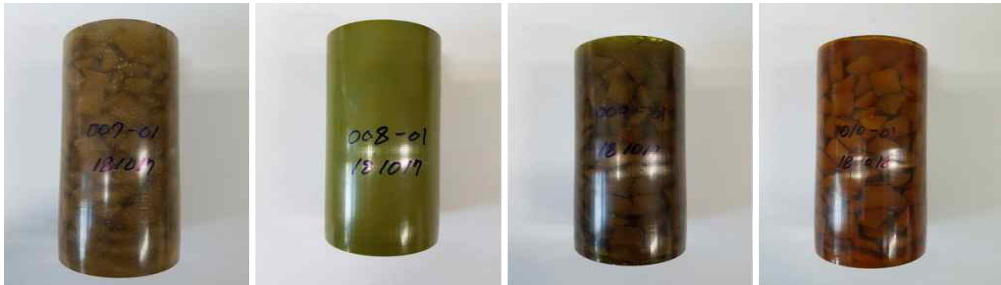
Fig. 40. 사진 특성평가에 사용된 고화체 시편 (007, 008, 009, 010)
