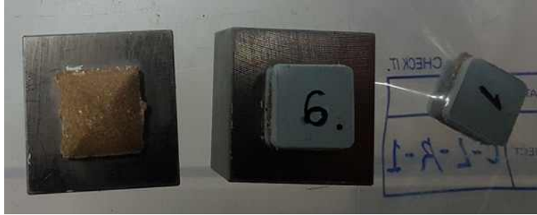
Fig. 27. 성형 펠릿 평가를 위한 지그와 강도 측정용 시편
