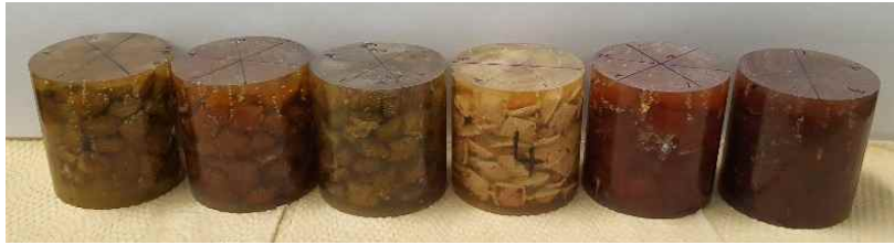
Fig. 71. 침출 시험 종료 후의 고화체 시편 모습
