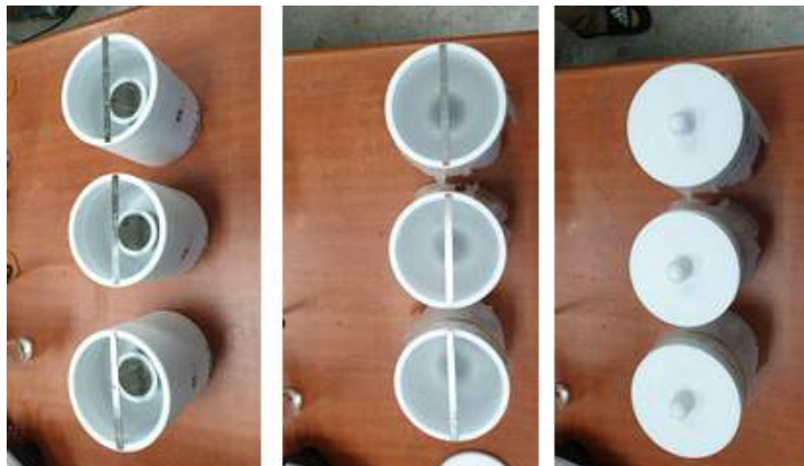
Fig. 52. 침출 시험 시편의 침출 용기 내 장착과 침출 시험 수행
