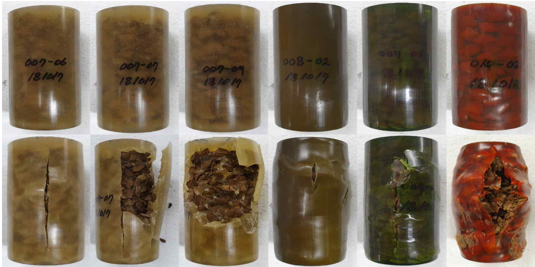
Fig. 68. 침수시험 후 시편(上) 및 침수시험 후 압축강도 측정 시편(下)
