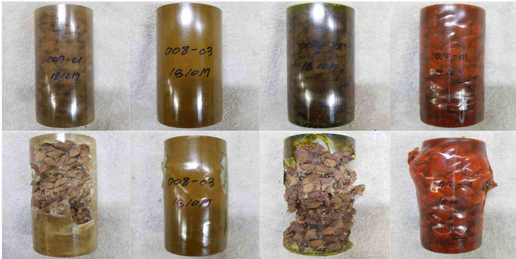
Fig. 62. 열 순환시험 후 시편 (上) 및 열 순환시험 후 압축강도 측정 시편 (下)
