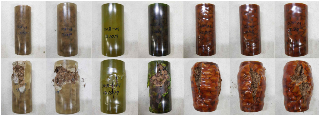
Fig. 53. 압축강도 시험 전·후 시편 (상; 시험 전, 하; 시험 후)
