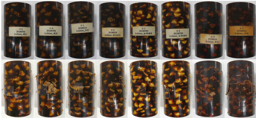
Fig. 70. 방사선 조사시험 후 시편 (上) 및 방사선 조사시험 후 압축강도 측정 시편 (下)
