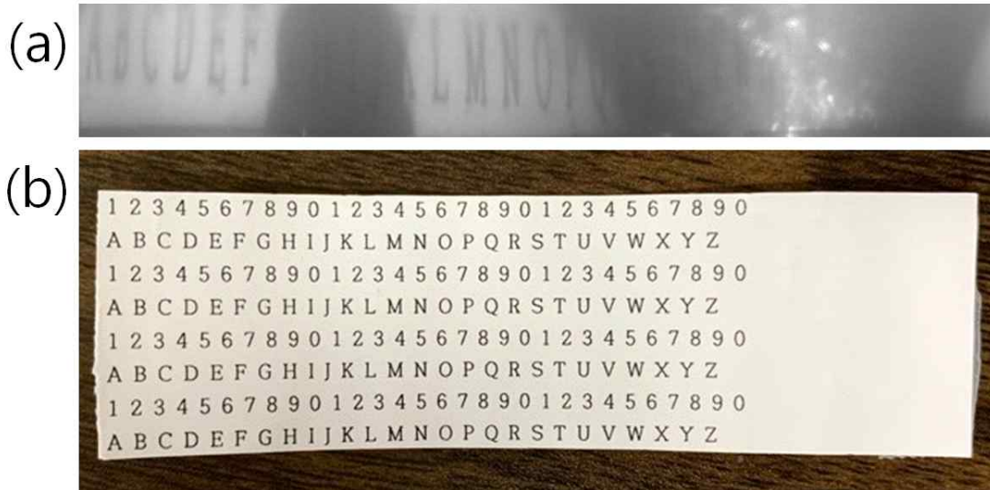
그림 3-11. (a) LED를 알파벳 대문자가 쓰인 종이샘플의 뒤에서 비추었을 때 랩뷰 프로그램을 통해 재구현된 평면 영상, (b) 알파벳 대문자가 쓰인 종이 샘플
