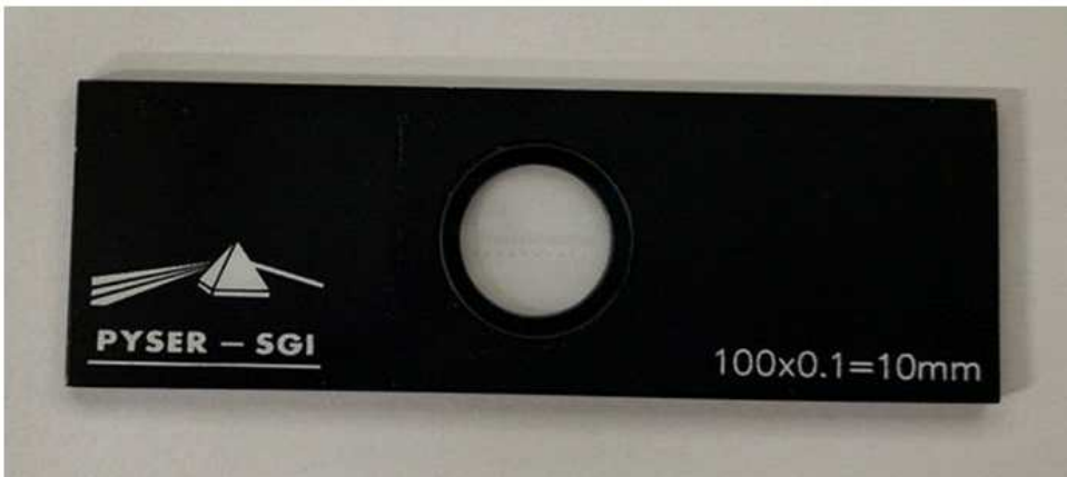
그림 3-5. (a) 광섬유 다발을 이용하여 0.1 mm 단위의 눈금이 새겨진 유리 샘플을 구현한 영상, (b) 0.1 mm 단위의 눈금이 새겨진 유리샘플
