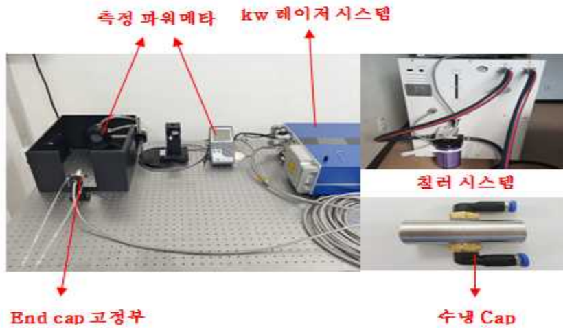
그림. 82 End cap 단계별 파워 테스트 시험 셋팅
