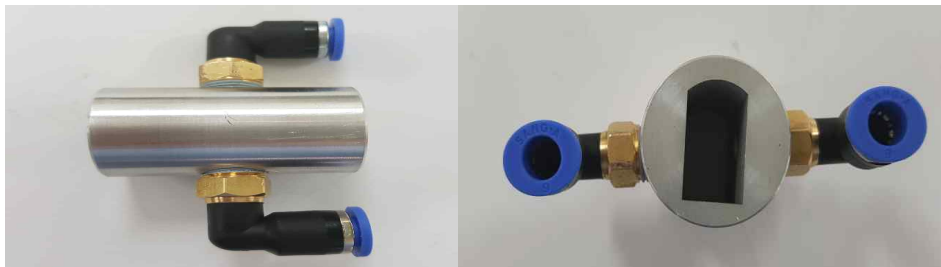
그림. 81 냉각을 위한 수냉 Cap 제작
