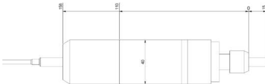
그림. 45 End cap 2D 외형도면
