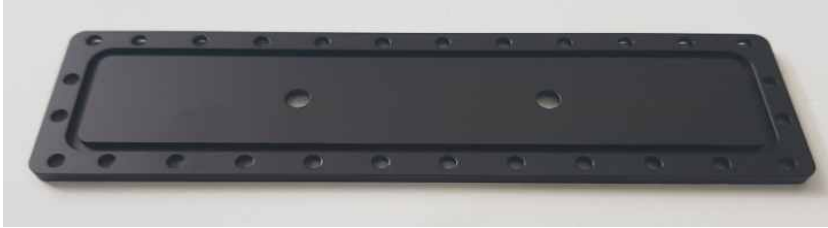
그림. 41 제작된 고출력 CLS 기구물 냉각 가이드 덮개
