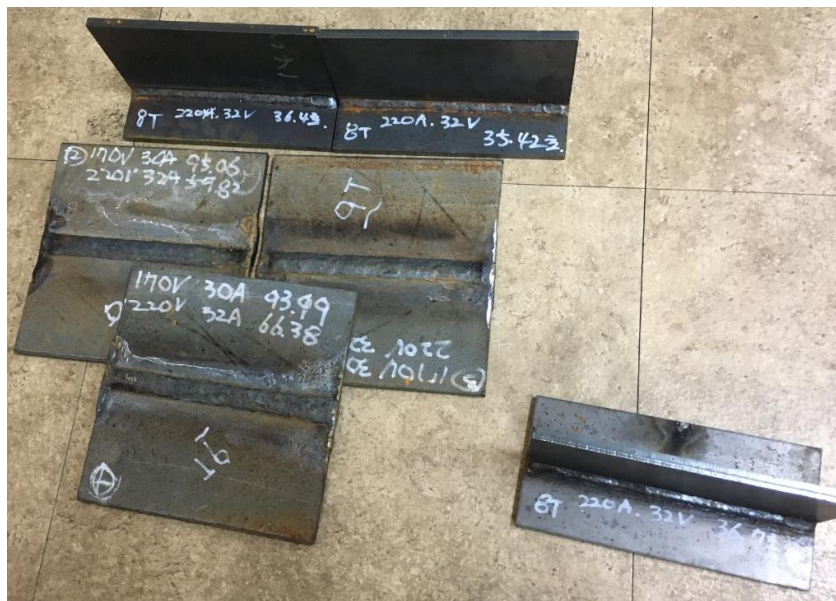
Fig. 8 전체 용접 시험편
