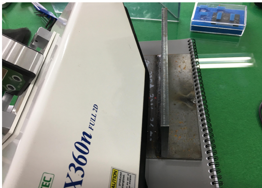
Fig. 11 필렛 용접부 잔류응력 측정
