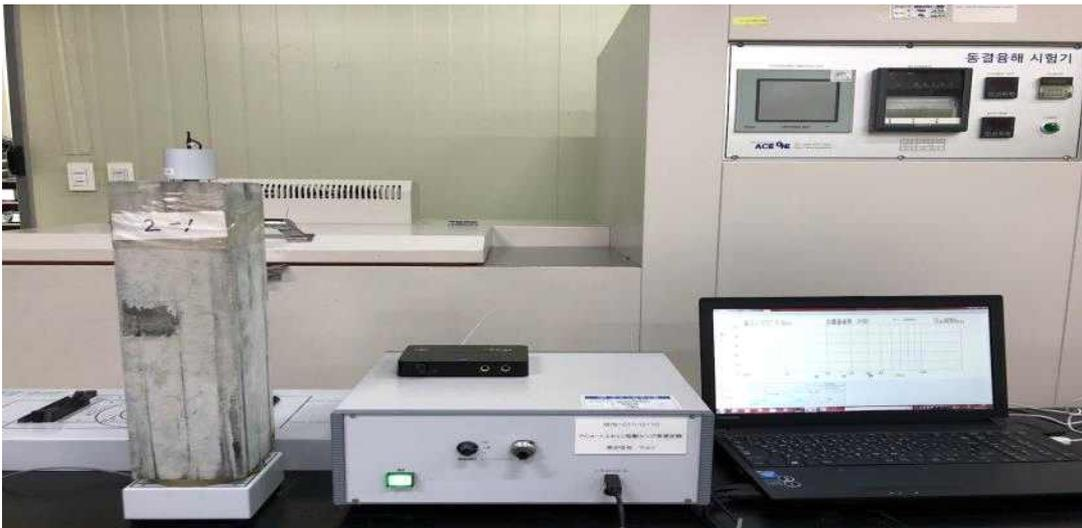
그림 3.19 동탄성계수 측정기 및 측정
