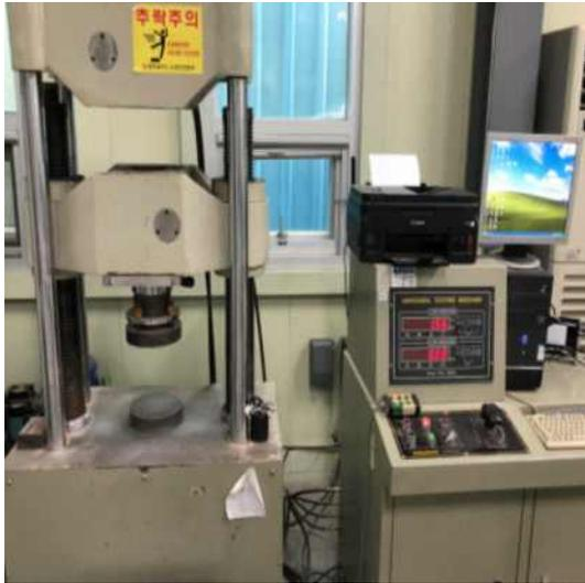
그림 3.12 압축강도 시험 장비
