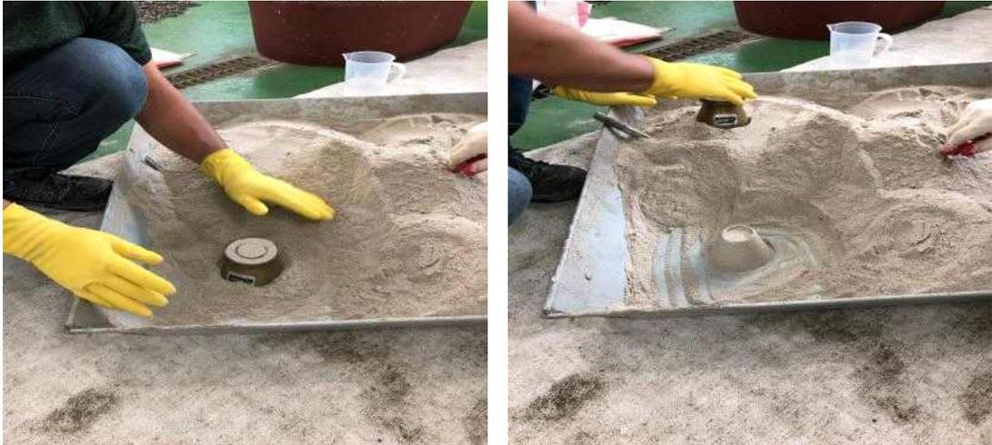
그림 3.2 잔골재의 표면건조 포화상태 시험
