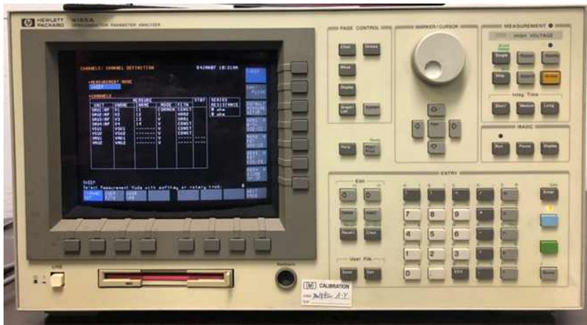
그림 15. 반도체 특성 분석기 HP4155-A(Hewlett Packard)
