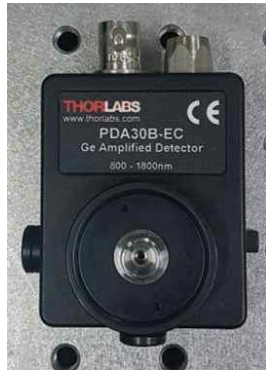
그림 3.14 PDA30B-EC - Ge Switchable Gain Photodetector
