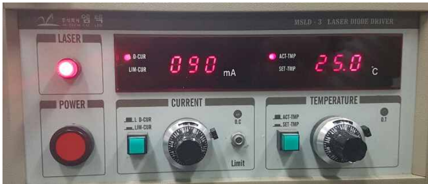
그림 3.12 MSLD-3 Laser Diode Driver와 전류, 온도 조절부분
