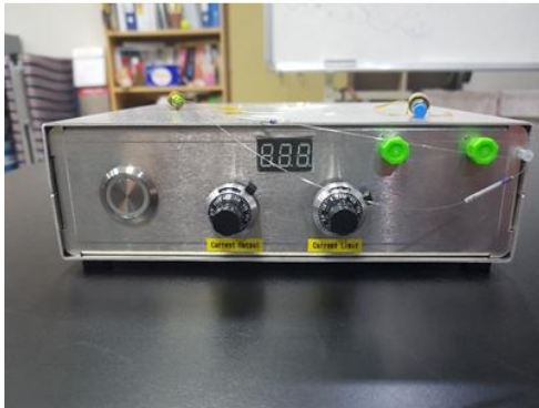
그림 3.8 본 연구에서 사용한 광 증폭기의 모습 및 성능 사양
