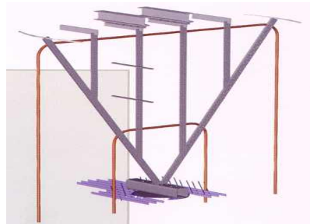
그림 2 - 8 증기발생기 진동 방지대(Anti Vibration Bar, AVB)
