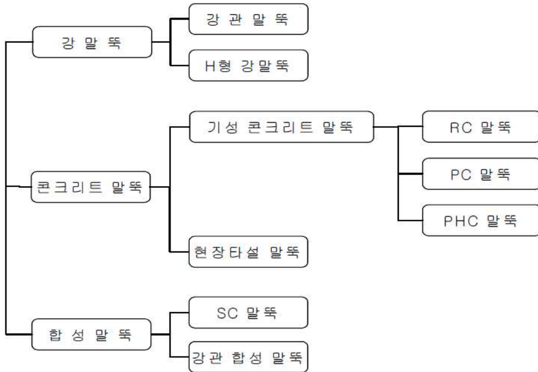
그림 2.3 말뚝의 재질에 의한 분류(한국지반공학회, 2002)
