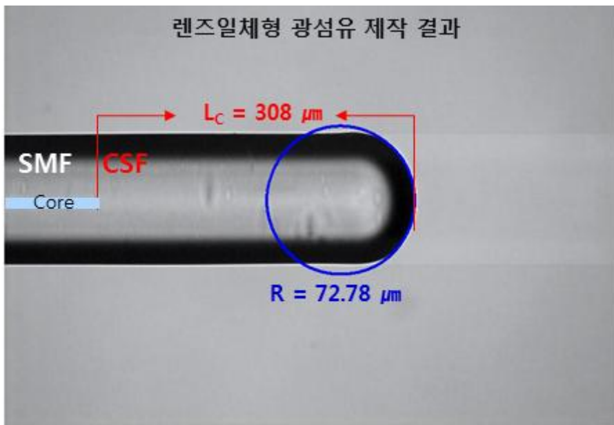
그림 33. 세점을 이용한 렌즈일체형 광섬유 곡률 측정
