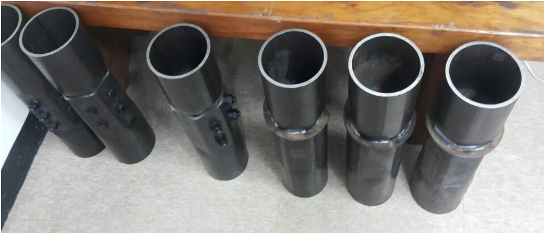
그림 2.12 제작 완료된 압축 및 인발 실험체
