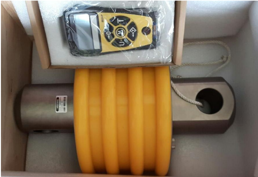
(a) Torque 트랜듀서(Torque 값 입력)
