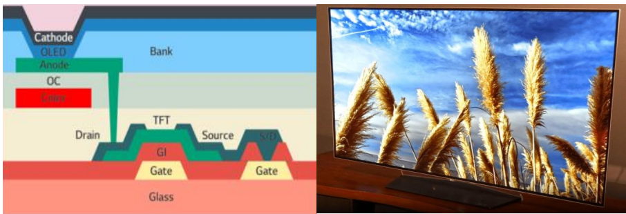
그림 2. OLED 디스플레이의 단면 구조 및 제품
