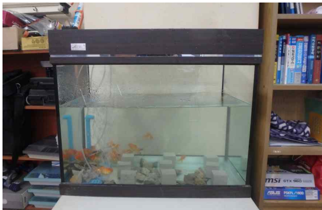
그림 3.10 어독성실험을 위한 고로슬래그가 포함된 공시체의 실험
