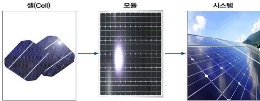
Fig. 2 태양광 어레이의 구성
