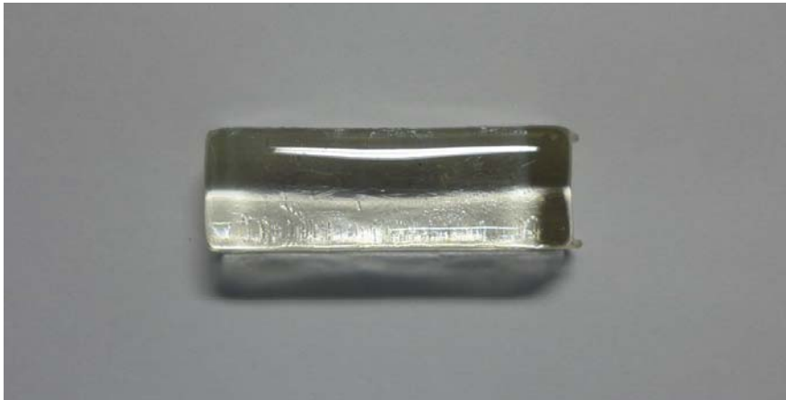
그림 3-2. 유리 용융법으로 제작된 TZBa-20 유리의 사진
