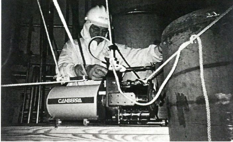
그림 16. ISOCS를 이용한 기기 측정 장면
