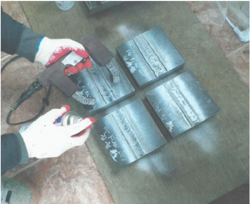
<그림 3-1> 자분탐상검사 (MT, Magnetic Particle Test)
