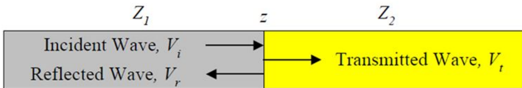
그림 2.10 입사파( V_i )의 두 전송선의 임피던스 차이로 인한 전송파( V_t ) 및 반사파( V_r ) 발생 현상(Drnevich 등, 2001a)
