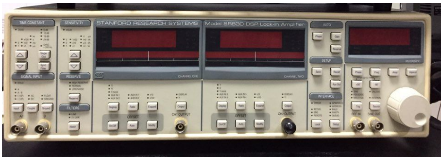
Fig. 3-10 LOCSET 방법에 사용된 lock-in-amplifier
