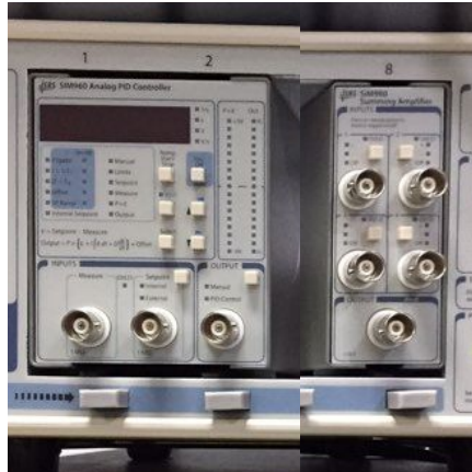
Fig. 3-11 LOCSET 방법에 사용된 PID control 및 summing amp
