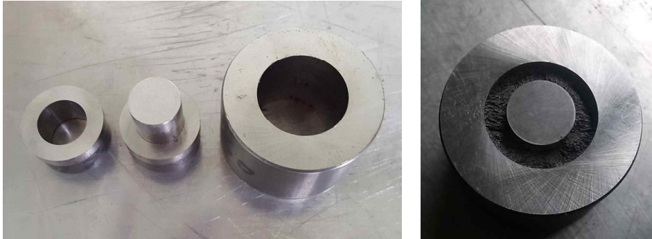
그림 4-9 다이 및 상, 하 펀치 Fig. 4-9 Die, upper and lower punch
