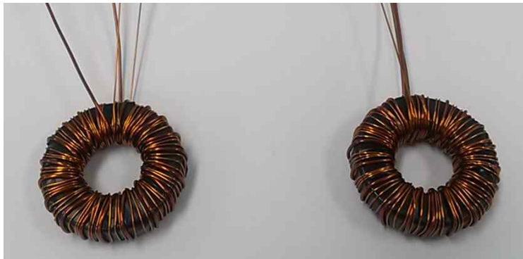
그림 4-13 코일이 와인딩된 복합 연자성 Toroidal 코어와 전기강판 Toroidal 코어 시편
