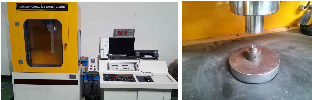
그림 4-10 복합 연자성 소재 압축 장비 Fig. 4-10 SMC compaction machine
