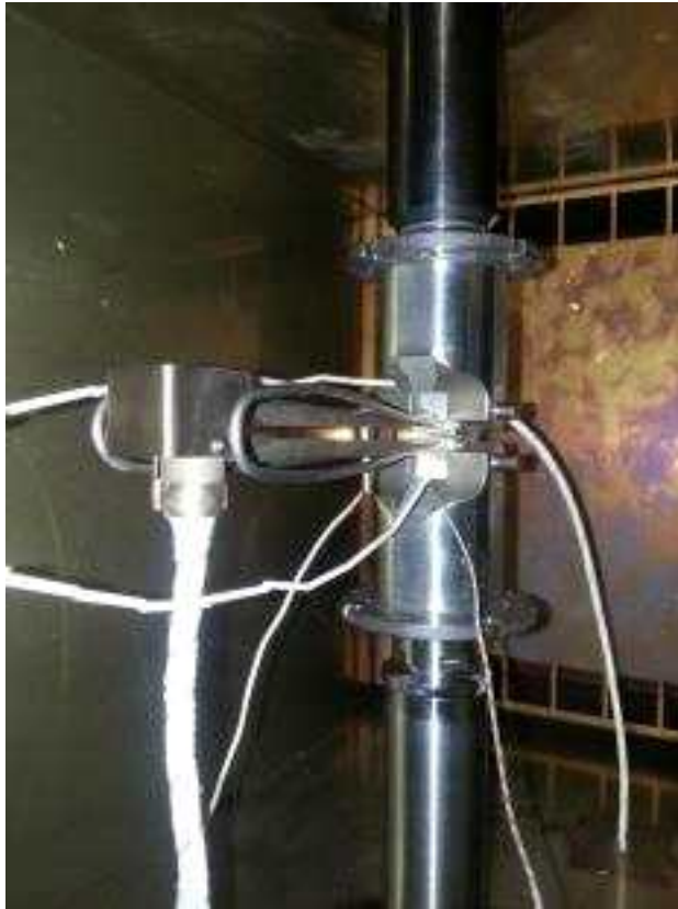
그림 2.2.2 Cyclic J-R 파괴인성시험 장면
