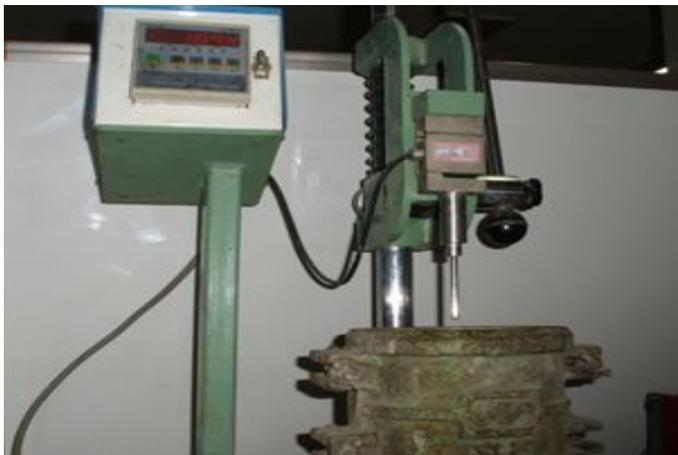
사진 3.6 응결시간 측정 관입저항 실험 장치
