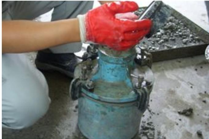
사진 3.3 콘크리트 공기량 시험 전경
