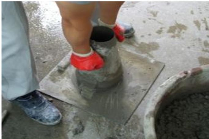
사진 3.2 콘크리트 슬럼프 시험 전경
