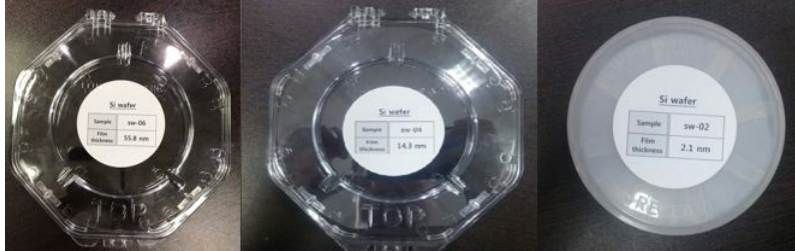
그림 34. 한국표준과학연구원(KRISS)에서 제공한 표준시편(2.1 nm, 14.3 nm, 55.8 nm)
