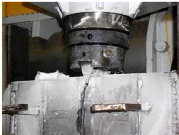
그림 3.22 ESSO 실험 후 모재의 균열진전형상(POSCO)
