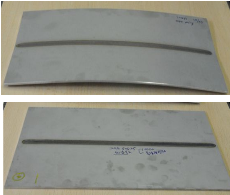
그림 4.9 최적 실험조건 BOP와 HSW 시편
