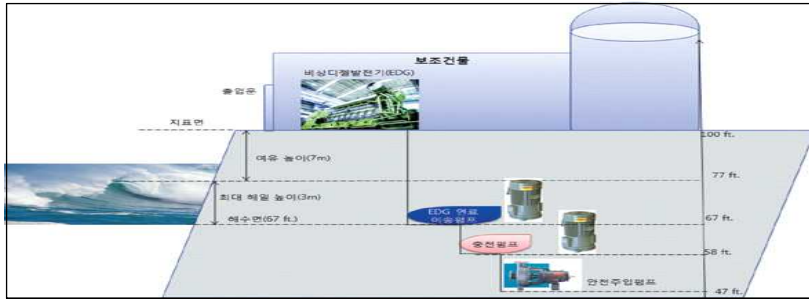
그림 2.1 - 설계기준 해일대비 주요 전기기기 설치 위치
