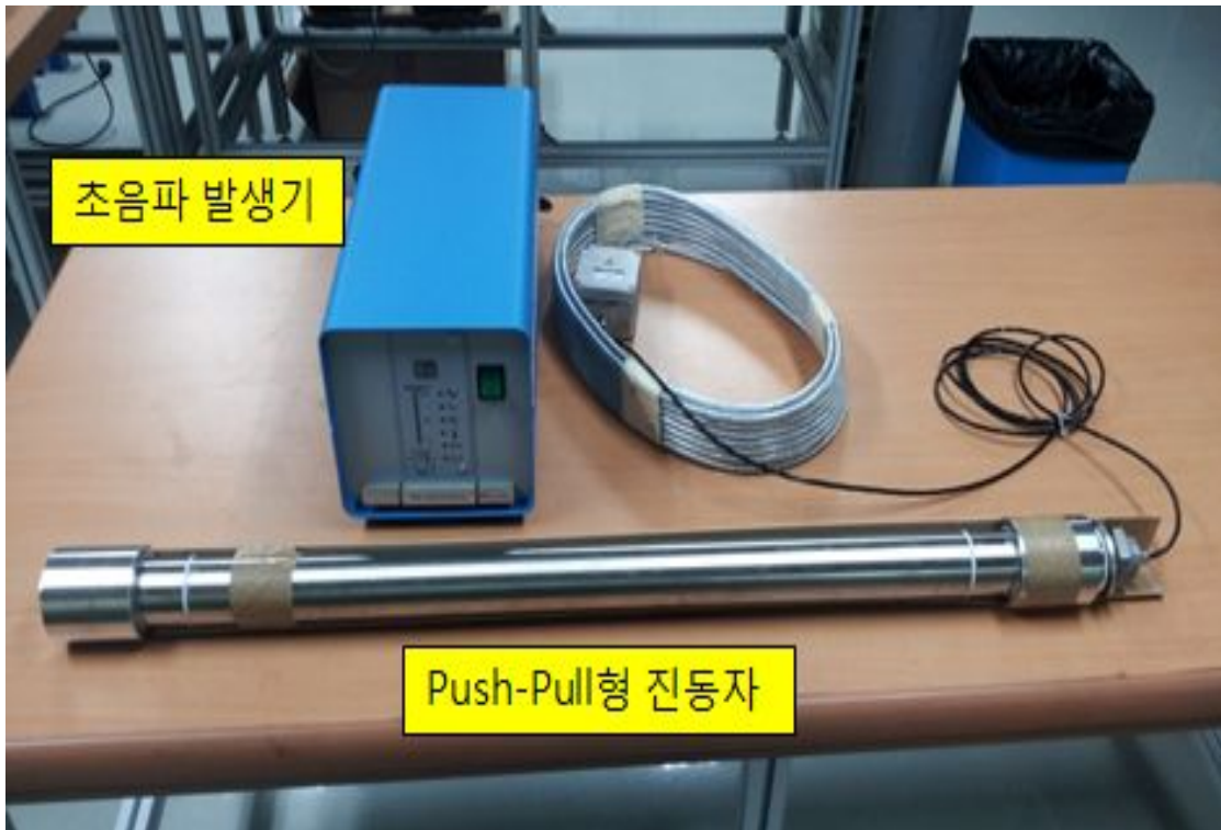
그림 7. Push-Pull형 초음파 발생기와 진동자
