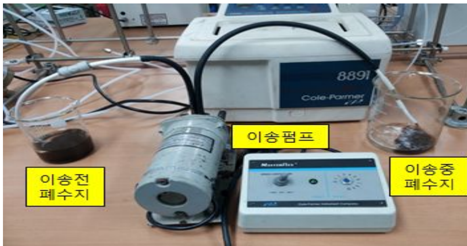
그림 2. 튜브 연동식 펌프를 이용한 폐수지 이송 실험
