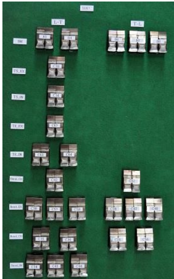
그림 3.2.1 J-R 파괴인성시험이 완료된 SA312 TP316 스테인리스강 시편
