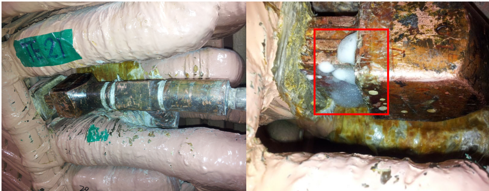
그림 4-5 TE측 20번 상부권선 Bubble Test
