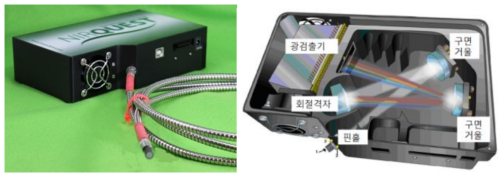
Fig. 3-4. 측정 시스템에 사용된 NIR 분광기와 광학 구성도
