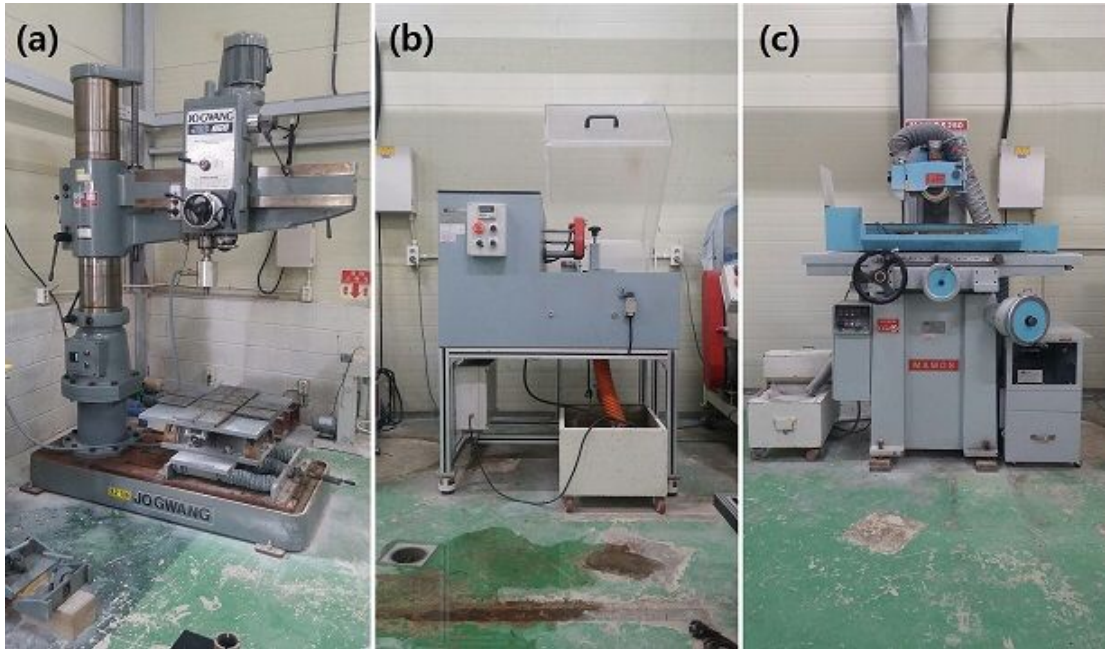
그림 4.1 시험편 제작 장비, (a) 드릴링머신, (b) 암석절단기, (c) 연마기
