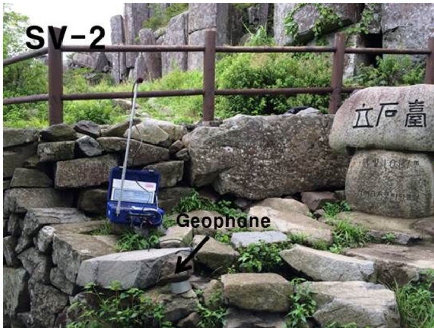
그림 4.15 진동소음 측정기 설치위치, SV-1(전망대 탐방로 부근), SV-2(입석대 표석지 부근)
