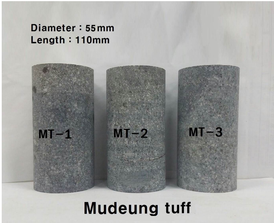
그림 4.3 무등산응회암 일축압축시험용 시험편
