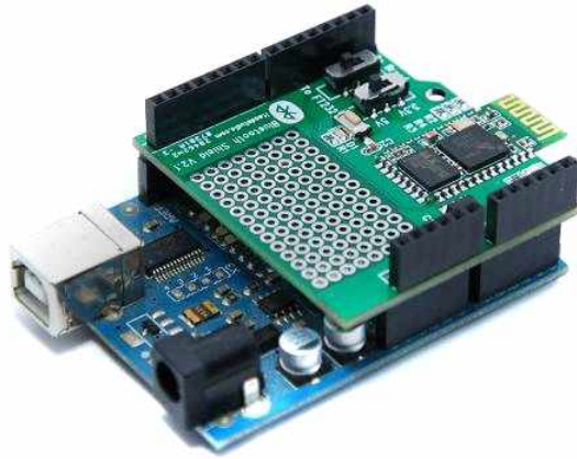
[그림 3-13] 아두이노 소켓에 장착하여 블루투스를 실현하는 블루투스 쉴드
