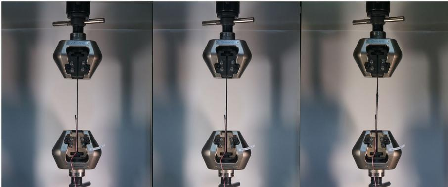
Fig. 26 A Process of Tensile Test  $[0_1/+45_4/-45_4/90_1]_s$
