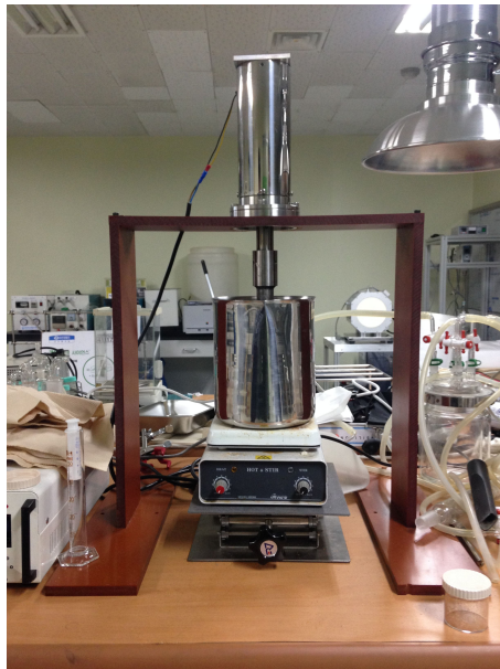
그림 15. 초음파를 이용한 폐수지 제염실험장치
