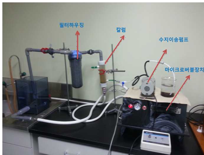
그림 17. 마이크로버블을 이용한 폐수지 제염실험장치
