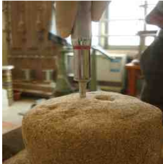
그림 4.20 일축압축강도 측정 모습
