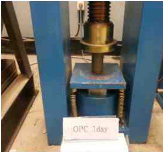
(c) 일축압축강도 측정 모습
