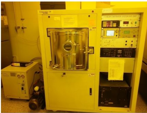
그림 3.1.8 전자빔증착(e-beam evaporation)장비와 증착 원리
