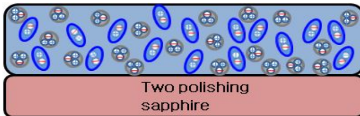
그림 3.6.2 형광체와 metal nanoparticle의 직접혼합에 따른 LSPR 시편의 개략도
